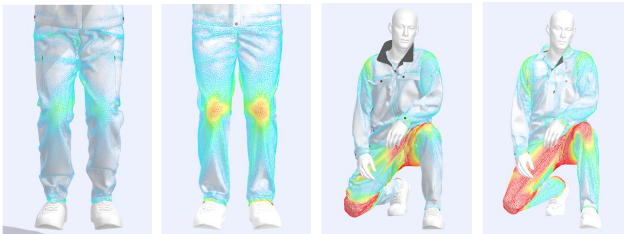
▲屈伸時の着圧比較 (左が東鉄工業の新ユニフォームパンツ、右が当社従来品)
